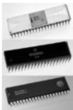
Reverzné inžinierstvo v praxi: hore americký čip Intel 8080A, v strede jeho sovietsky klon KR5801K80A, dole československý klon TESLA MHB 8080A, ktorý sa vyrábala v podniku Tesla Piešťany.
